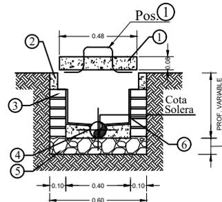
DETALLES CÁMARA DE INSPECCIÓN
