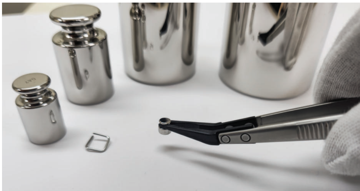
Personal de IBMETRO calibrando pesas patrón, para la industria farmacéutica
